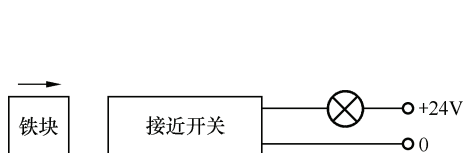
图 1-20 接近开关与指示灯相连的示意图
