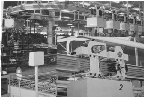
图 3-41 生产线上的电轨小车
