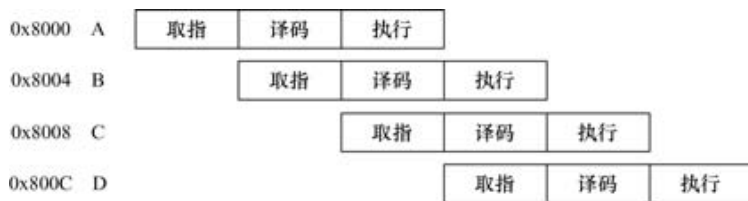
图 2-2 ARM 状态下三级指令流水线执行示例
