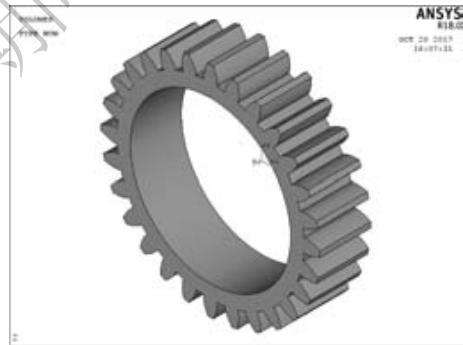
图 3-52 生成齿轮外圈的最后结果
