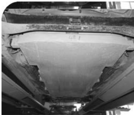
图 1-23 安装在汽车车底部的动力电池
