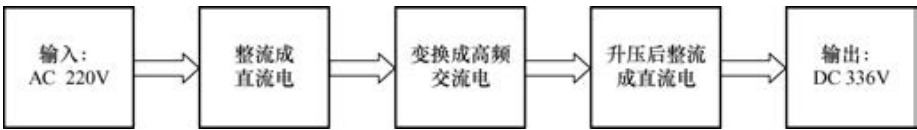
图 1-14 充电机电流变换模块图
