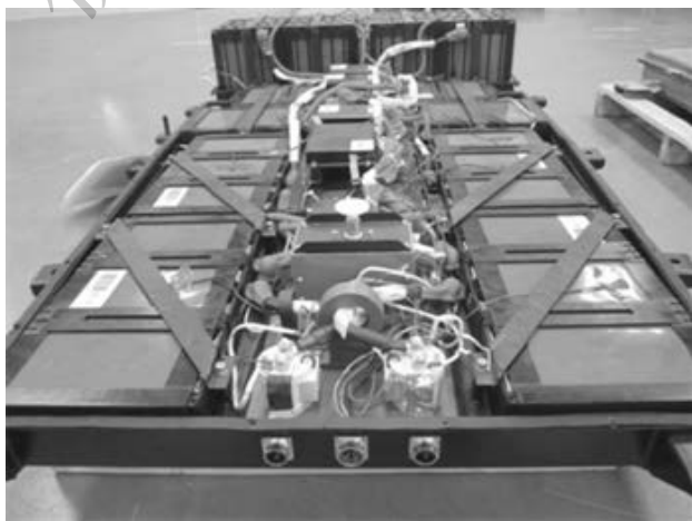
图 1-26 动力电池内部的辅助材料
