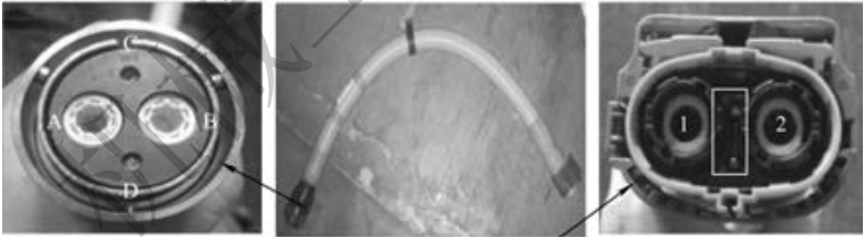
图 1-40 动力电池高压电缆
