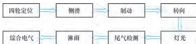
图3-6 整车检测线的一般组成
