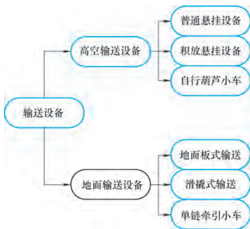
图 3-8 汽车装配用输送设备
