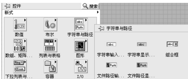
图 3-10 字符串与路径控件子选板
