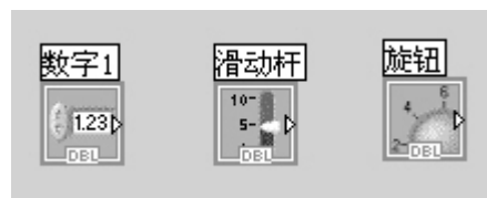
图 2-17 程序框图窗口中自动生成的图标
