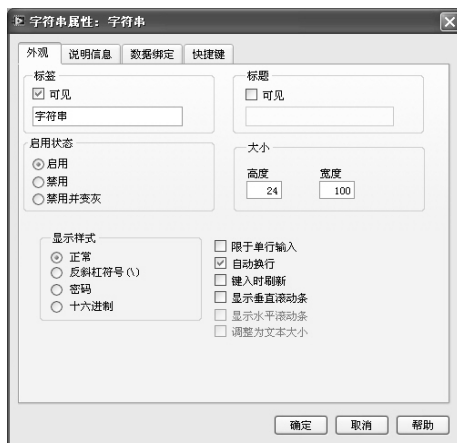
图 3-13 字符串型控件的属性对话框
