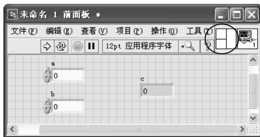
图 2-37 选择的连接端口
