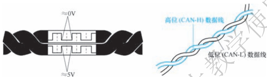
图 3-29 CAN 数据传输线
