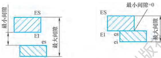
图 2-5 间隙配合尺寸示例
