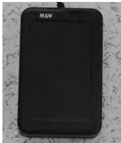
图3-35 RFID中距离一体机实物图
