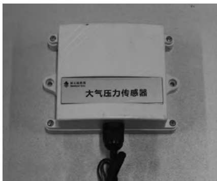
图3-2 大气压力传感器实物图
