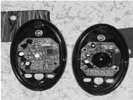
图3-22 红外对射传感器实物图
