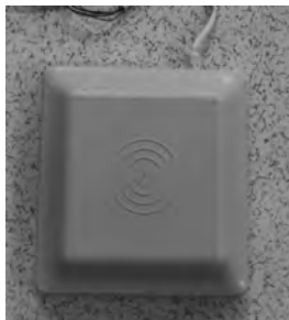
图3-34 RFID中距离一体机实物图
