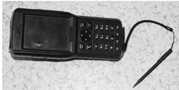
图3-31 UHF手持机实物图
