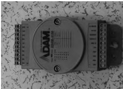
图3-15 数字量采集模块实物图
