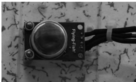
图3-1 空气质量传感器实物图
