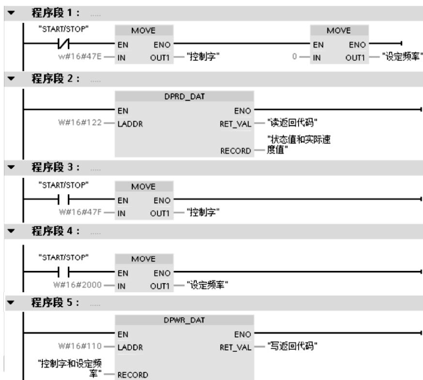
图 3-47 主站 PLC 的 Main[OB1] 程序
